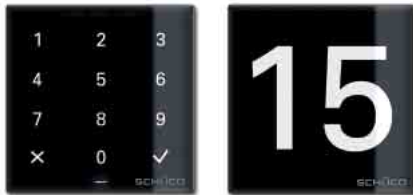
Schüco DCS Module: Keypad und dezert beleuchtete Hausnummer Schüco DCS modules: Keypad and discreetly lit house number
