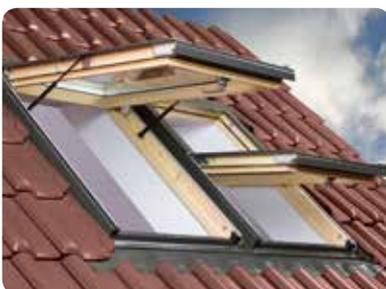
Die Dachfenster OptiLight VK werden in Dächer mit einer Neigung von 20° bis 55° eingebaut. Hierfür stehen die Standard-Eindeckrahmen TZ, TH, TL und TS zur Verfügung. Für die Ausführung VK empfehlen wir besonders den Eindeckrahmen TZ-K.
